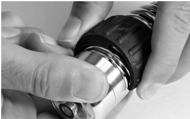
Figura 34 – Empleo del semicírculo de plástico negro (incluido) para separar la cámara del resorte
