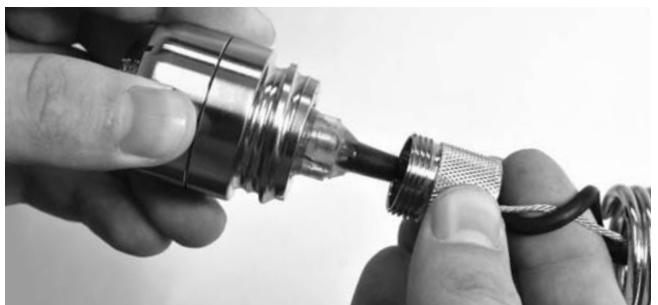
Figure 37 – Retrait du manchon de verrouillage de la tête de caméra
