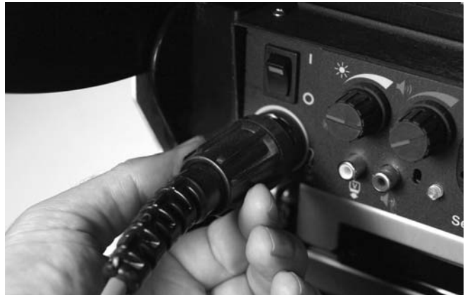
Figura 24 – Conexión del enchufe del cable del sistema a la UCC
