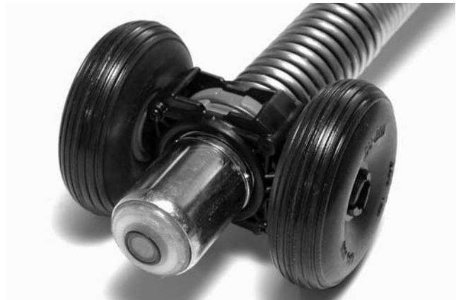
Figura 21 – Carrito rodante instalado
