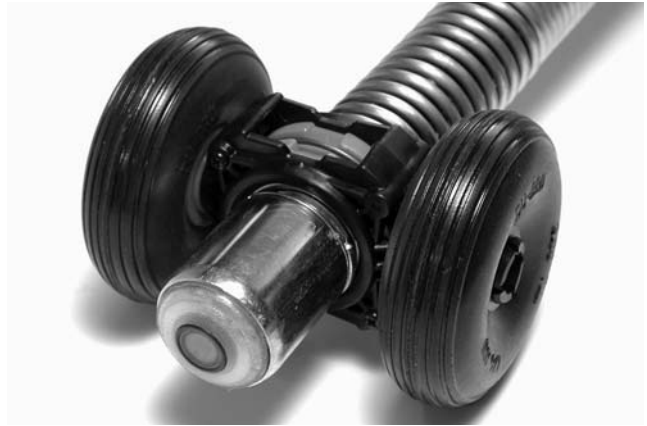
Figure 21 – Cerclip du chariot à roues fermés
