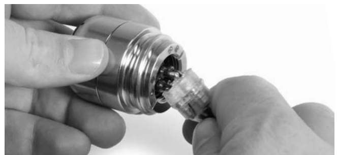
Figura 38 – Manera como se desenchufa la cámara
