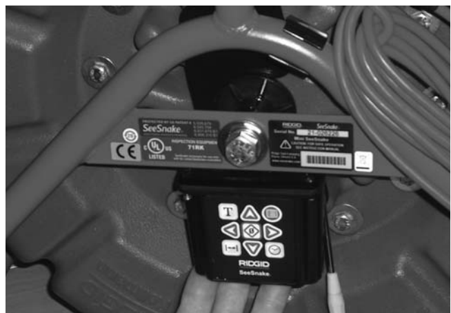
Figura 39 – Extracción del CountPlus
