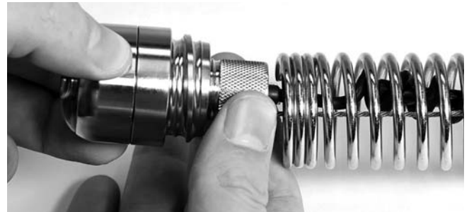
Figura 36 – Forma de separar la cámara de la manga de retención
