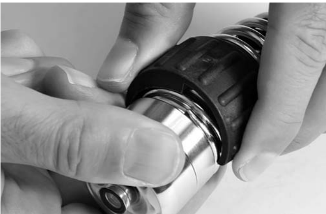
Figure 34 – Dévissage de la tête de caméra à l'aide de la clé à ressort
