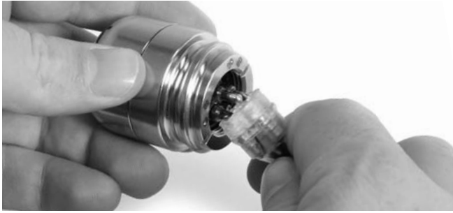
Figure 38 – Débranchement de la tête de caméra
