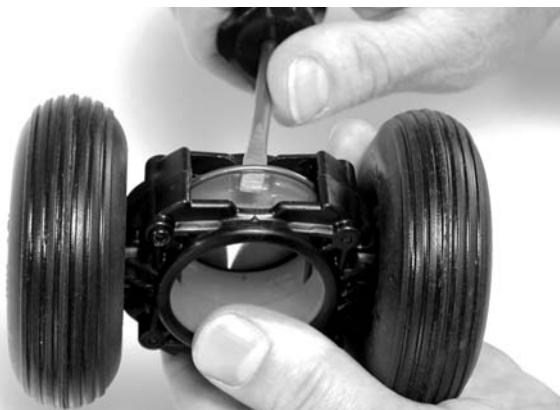
Figure 20 – Ouverture des cerclip du chariot à roues
